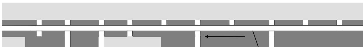
Рис. Система разработки длинными столбами по простиранию с выемкой столбов к заднему бремсбергу
